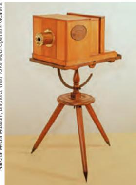
O daguerreótipo foi utilizado mais intensamente no século XIX. Seu processo fotográfico era pioneiro. Ele tem um orifício por onde entra a luz, que impressiona uma chapa metálica especial ao fundo. Sob sol intenso, o modelo ficava parado pelo menos 10 minutos até a fotografia ficar pronta.
